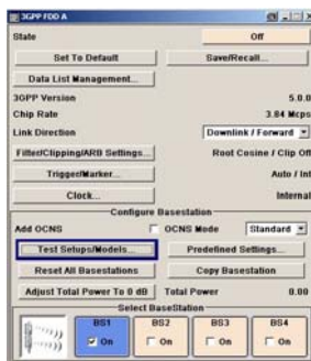
Fig. 3: El sistema de 3GPP FDD del SMU200A con opción a visualizar el dominio del código.
